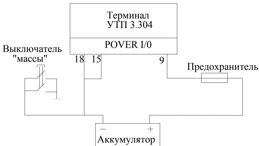
Рисунок 14.4 – Вариант подключения устройства (при размыкании «массы», устройство функционирует до разряда внутреннего аккумулятора)
